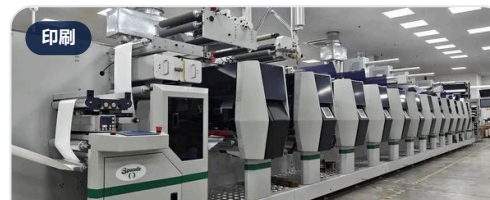
Spande 柔版印刷机 多色柔印生产线，配合联线印后单元。
