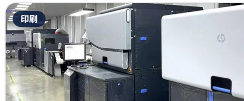
HP Indigo WS6800 数码印刷机 电子油墨数码印刷，7 色含白墨与荧光墨，小批量多 SKU 零版费，可变数据。
