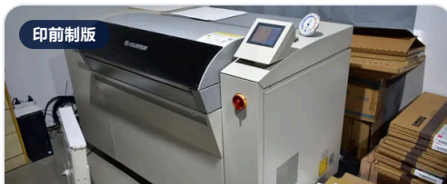
富士 Luxel T-6000 CTP 制版机 计算机直接制版，柔印与胶印印版高精度输出。
