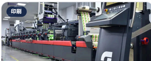
OMET KFLEX 430 柔版印刷机 430 mm 幅宽多色柔印，联线冷烫、覆膜、模切，大批量高效生产。
