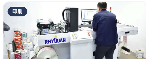
J-550S 喷码机 每枚不同的二维码、条码与序列号在线喷印，防伪溯源核心设备。
