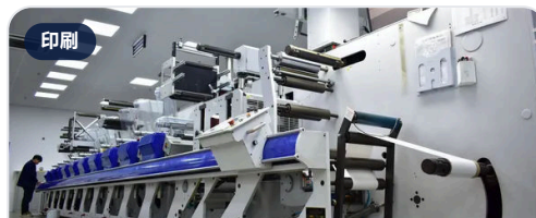
伟岗 ZJR-330 柔版印刷机 330 mm 柔印，专色与实地印刷稳定，适合封签与色块标签。
